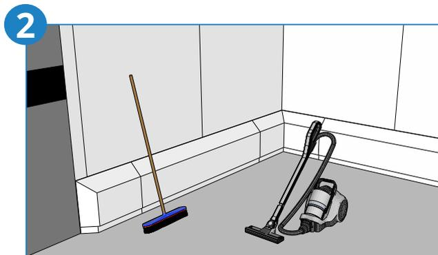
2 Après l'installation, toutes les poussières et taches superficielles doivent être éliminées. Nettoyez la surface et ouvrez le joint avec HygiClean. Il est important qu'il n'y ait pas de poussière dans la zone qui peut être gonflée et se retrouver dans le joint fraîchement appliqué.
