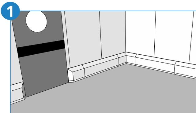
1 Installez les banquettes PolySto et / ou les plaques FRP B-Hygienic conformément aux guides d'installation correspondants. Un joint de  $\pm 4$  mm doit être créé entre chaque banquette et / ou panneau FRP. Lorsque le joint entre la banquette et le panneau / sol dépasse 6 mm, appliquez toujours un fond de joint ronde.
