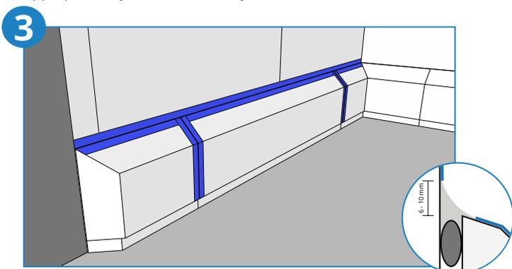
3 Fixez le ruban Hygiseal de chaque côté du joint à environ 2 mm du bord pour créer un chevauchement lorsque l'application de l'Hygiseal 3.1. Ce chevauchement se traduira par un joint vertical beaucoup plus solide. Pour les joints horizontaux entre la banquette et le panneau, appliquez un espacement de 6 à 10 mm (ceci est une ligne directrice et dépend du type de banquette et de la distance entre la banquette et le mur).
