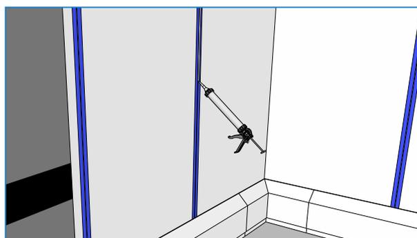
4 Dispersez l'Hygiseal 3.1 à l'aide d'un pistolet de 600 cc manuel, pneumatique ou avec batterie sous un angle de 45°.
